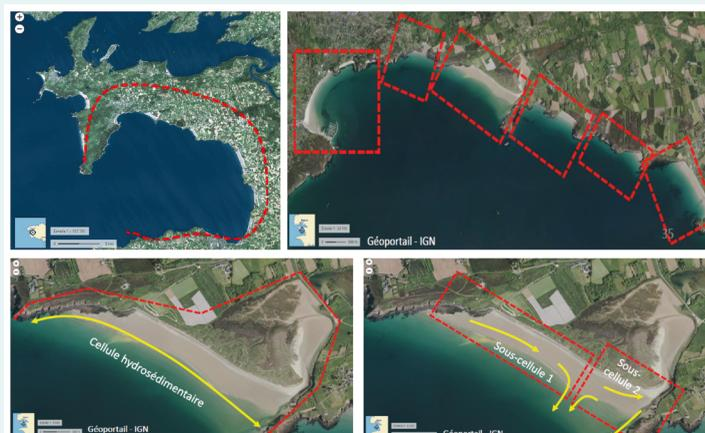
**Figure 8 : Emboîtement d'échelle du découpage hydro-sédimentaire du littoral.**
