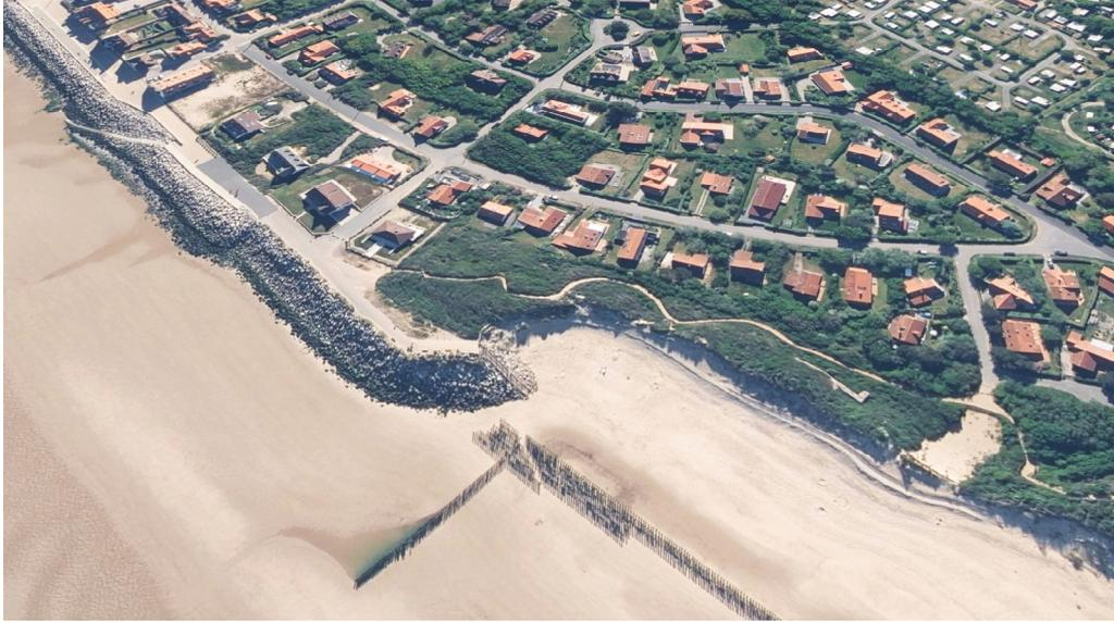
Figure 24 : Illustration d'un recul accru à l'extrémité d'un ouvrage. Géoportail.
